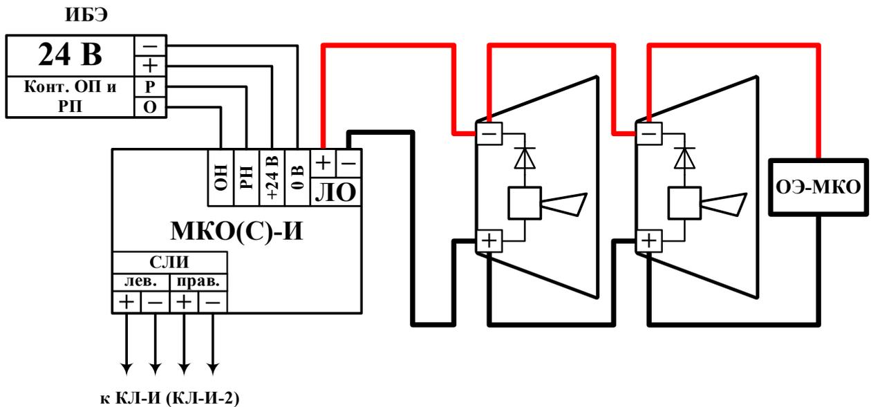
Рисунок 142 – Схема подключения оповещателей к МКО(С)-И.
