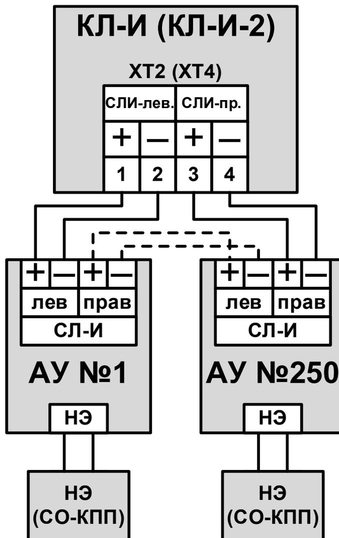
Рисунок 119 – Общая схема подключения АУ к КЛ-И (КЛ-И-2).
