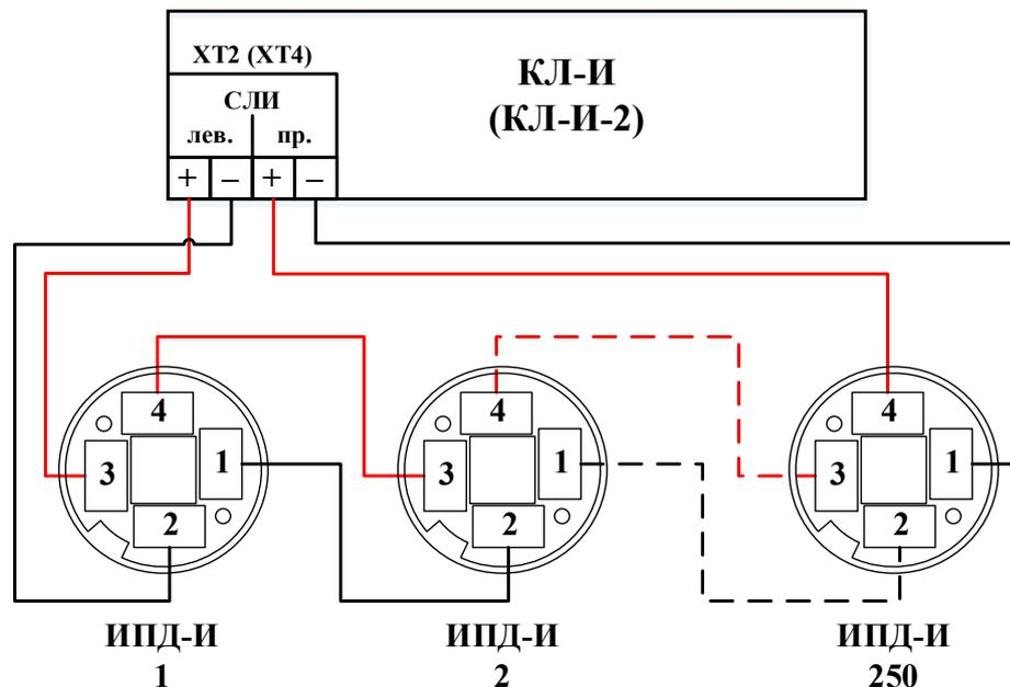
Рисунок 130 – Схема подключения ИПД-И к КЛ-И (КЛ-И-2).
