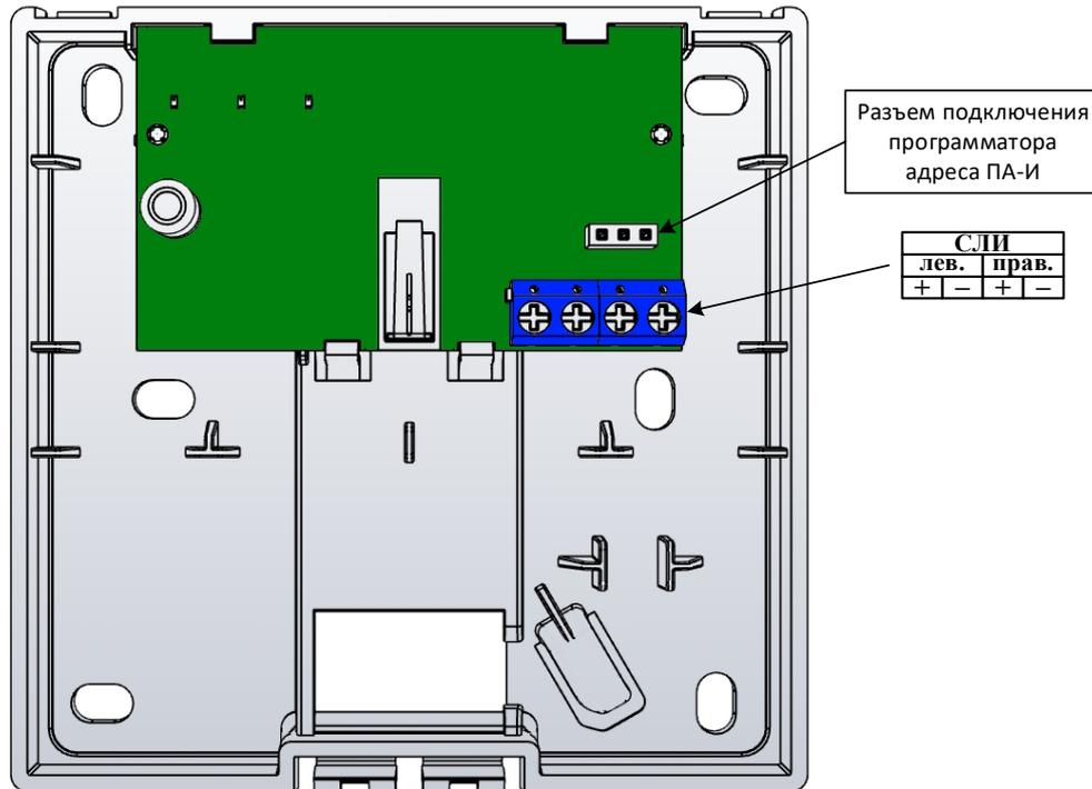
Рисунок 137 – Клеммы подключения внешних цепей к ИПР-И, УДП-И.
