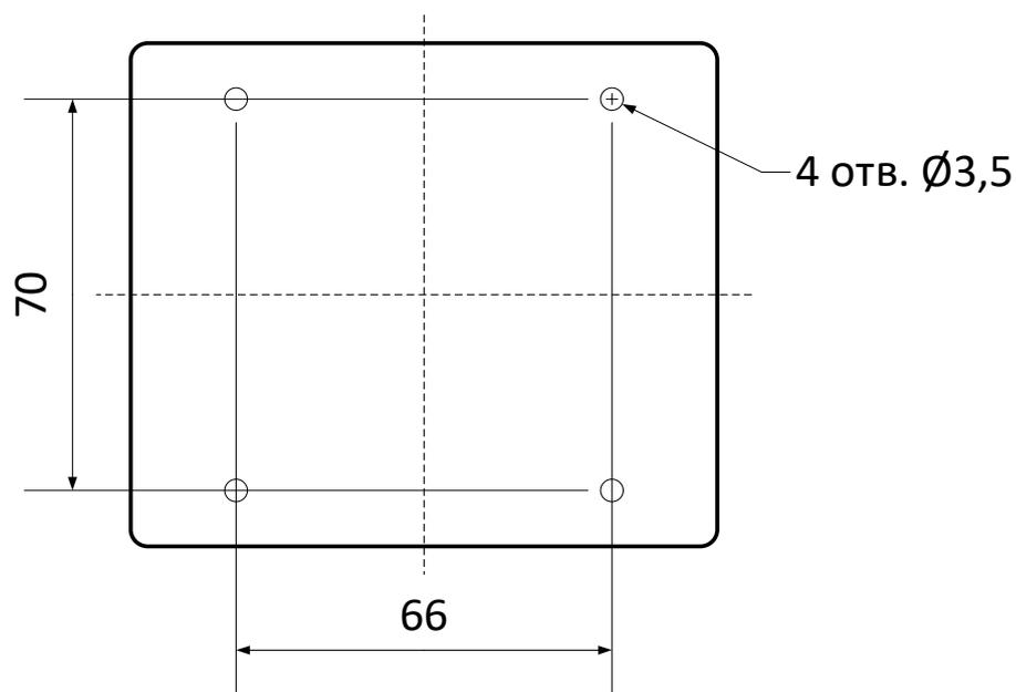
Рисунок 144 – Установочные размеры модулей МКО.
