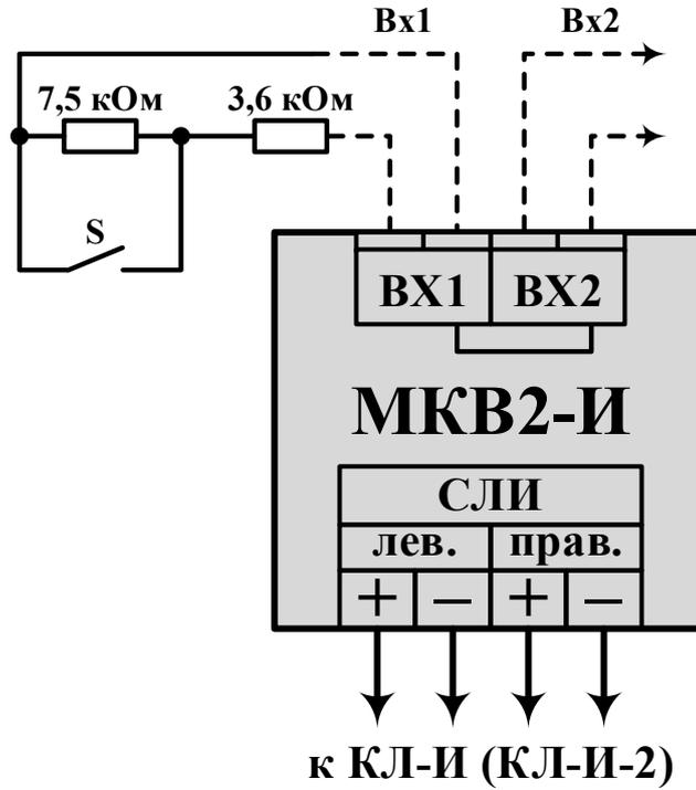
Рисунок 146 – Схема подключения внешних цепей к модулям контроля входов (на примере МКВ2-И).
