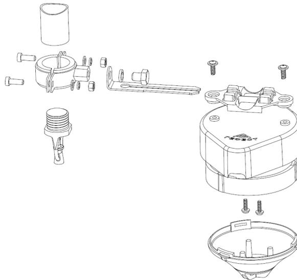
Рисунок 124 – Схема установки ИПТ-СИ-л и МКС-И-л на кронштейн.
