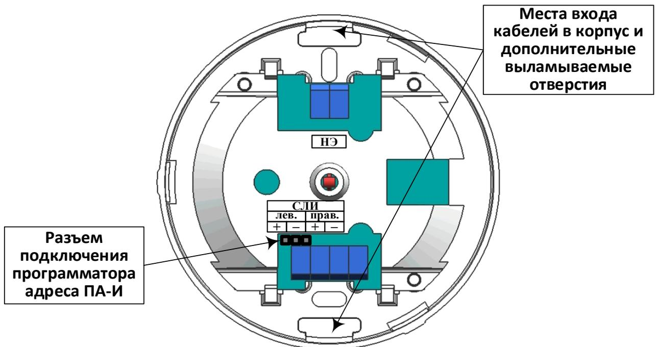
Рисунок 120 – Клеммы подключения внешних цепей к ИПТ-СИ-л, ИПТ-И-л, МКС-И-л.
