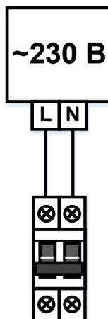
Рисунок 35 – Подключение сети электропитания к БКУ-И.
