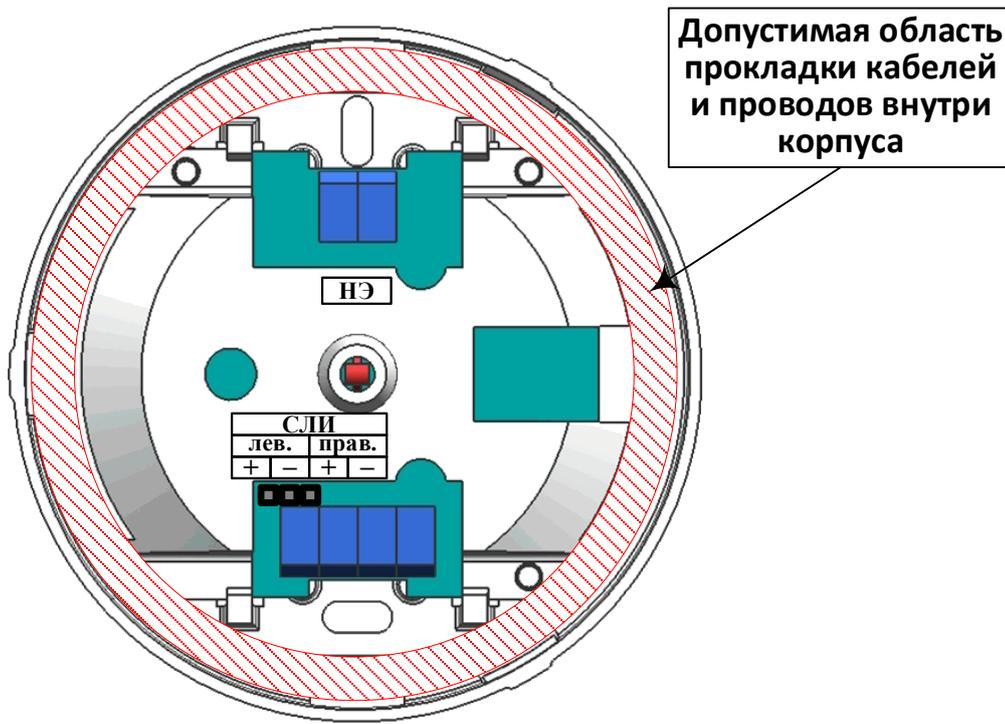
Рисунок 121 – Области прокладки кабелей (проводов) внутри ИПТ-СИ-л, ИПТ-И-л, МКС-И-л.
