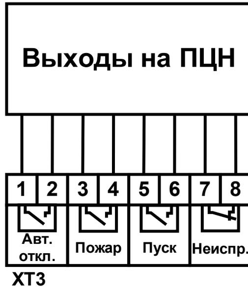
Рисунок 39 – Контакты для подключения выходов на ПЦН.
