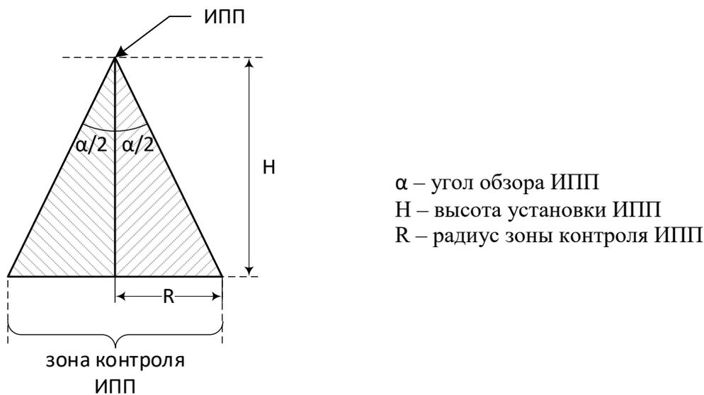
Рисунок 133 – Размер зоны контроля ИПП (вид сбоку).
