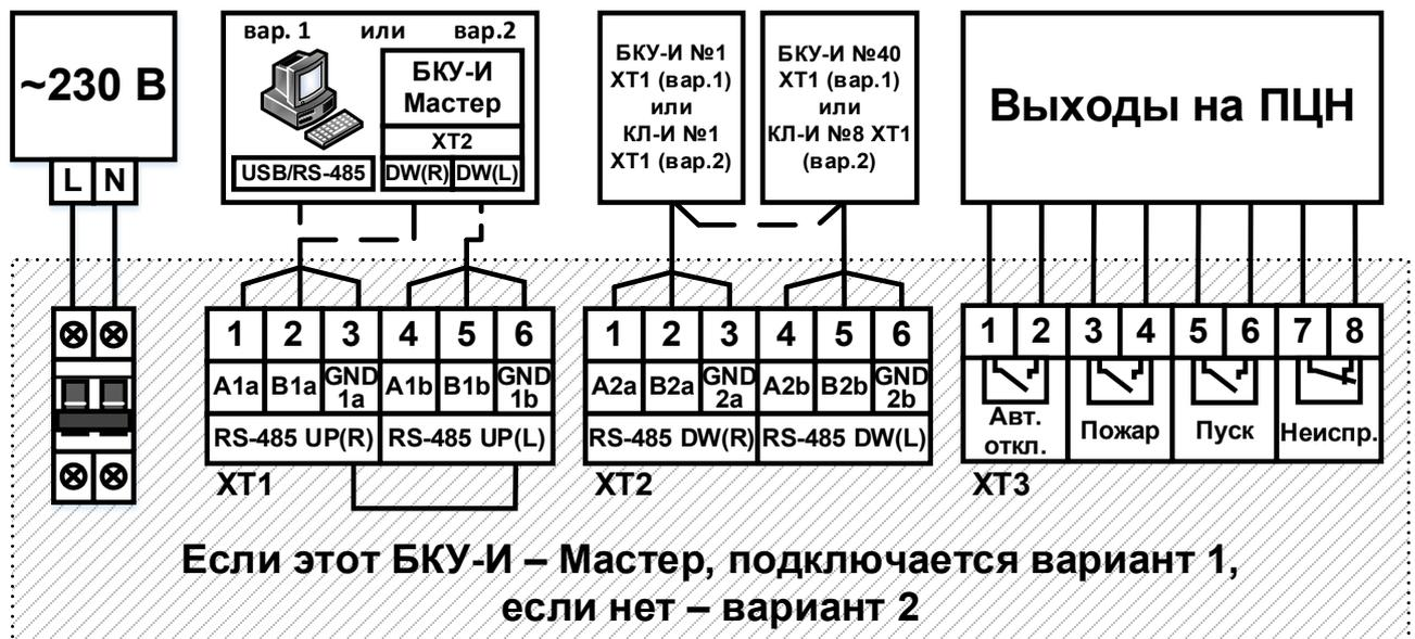
Рисунок 34 – Общая схема подключений БКУ-И.
