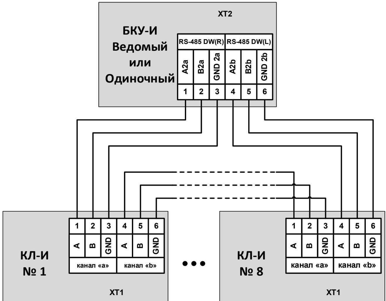
Рисунок 38 – Подключение к БКУ-И кольцевой линии с КЛ-И, КЛ-И-2.
