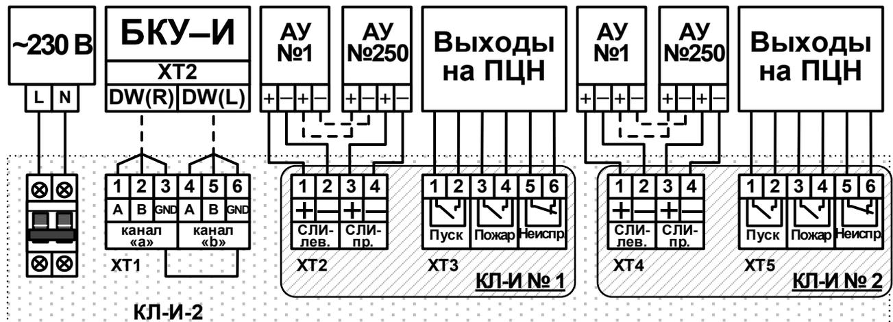
Рисунок 117 – Схема подключений КЛ-И-2.
