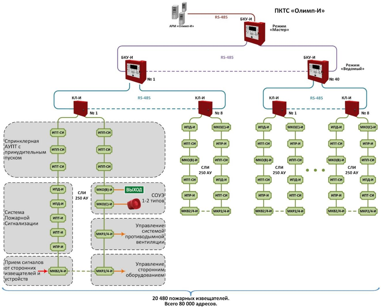
Рисунок 2 – Сетевая система ПКТС (с несколькими БКУ-И), количество АУ – до 80 000, из них 20 480 \* ИП.
