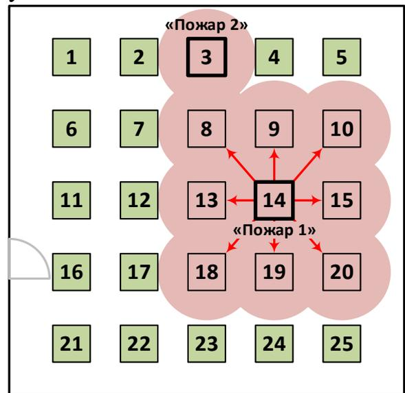
Алгоритм пуска, когда «Пожар» поступил сначала с извещателя №3, затем с извещателя №14.
