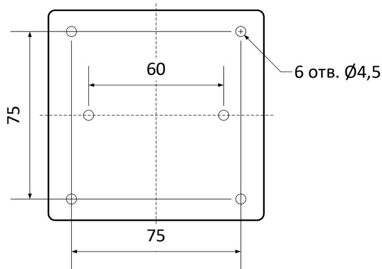
Рисунок 138 – Установочные размеры ИПР-И, УДП-И.
