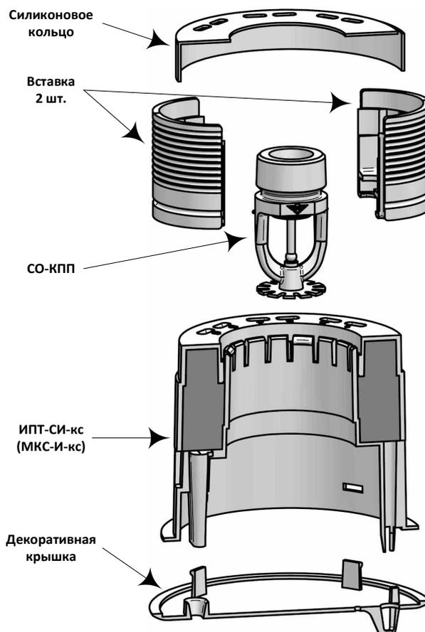
Рисунок 128 – Схема установки ИПТ-СИ-кс и МКС-И-кс на СО-КПП.
