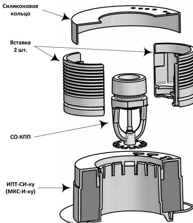
Рисунок 127 – Схема установки ИПТ-СИ-ку и МКС-И-ку на СО-КПП.
