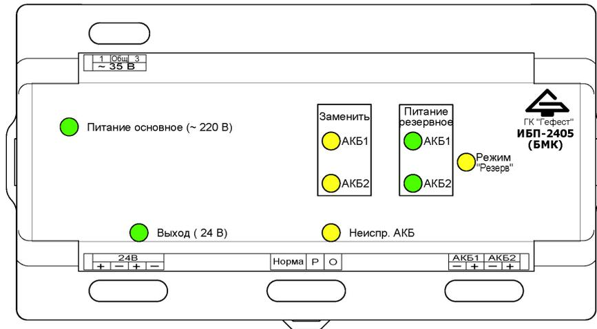
Рисунок 6 – Внешний вид модуля питания ИБП-2405.
